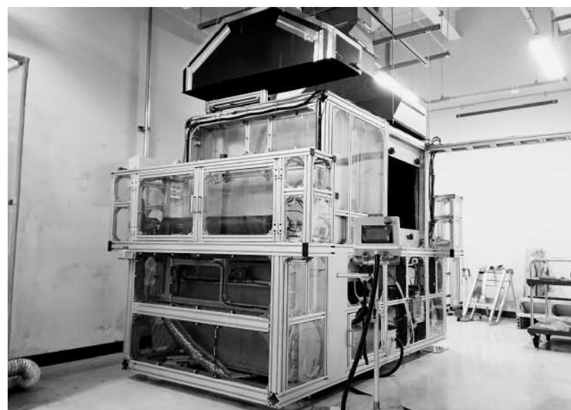
CFRシート量産化に向けて前処理工程の自動化設備を自社開発した
